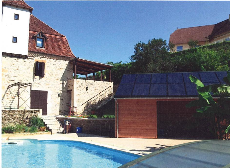
Un des avantages des panneaux hybrides comme ceux de Dualsun se situe au niveau architectural. Ils permettent en effet d'installer un système solaire en toiture d'aspect homogène, produisant à la fois chaleur et électricité. [dualsun.com](http://dualsun.com)
